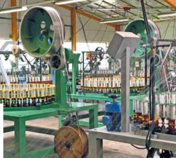
Oben: Flechtmaschinen produzieren aus Glasfilamenten die Basis für Isolierschläuche
